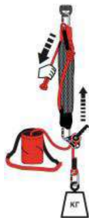
Комплект для эвакуации (Полиспаст ST + Десантер)
