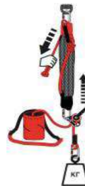
Комплект для эвакуации (Полиспастр ST + Десантер)
