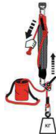
Комплект для эвакуации (Полиспаcт ST + Десантер)
